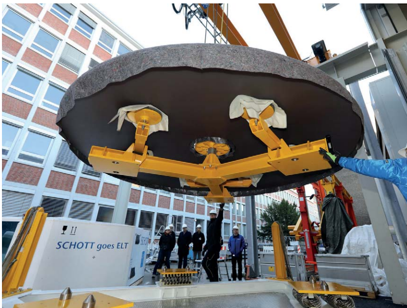
Der Sekundärspiegelträger für das ELT ist zehn Zentimeter dünn – und das bei extremer Krümmung, 4,25 Meter im Durchmesser und hat drei Tonnen Gewicht. (Foto: SCHOTT)
