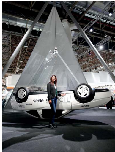
Superdünne Glasscheiben halten ein Auto. (Foto: Messe Düsseldorf/ctillmann)
